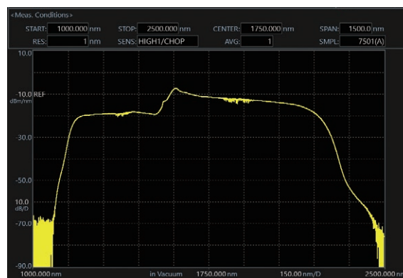
2 \mu m超连续光谱光源的测量实例(使用扩展机型)
