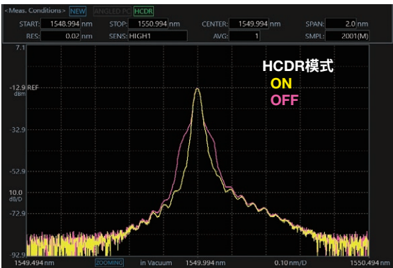
HCDR模式示例 分辨率设置0.02nm，高性能机型
