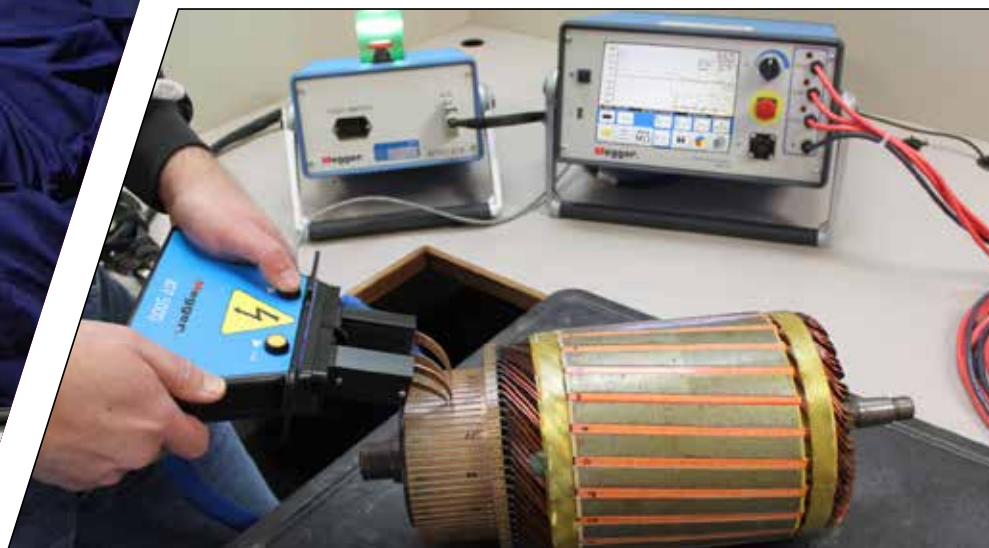
使用ATF5000和BAKER ZTX低阻抗测试附件来非常容易的测试电枢
