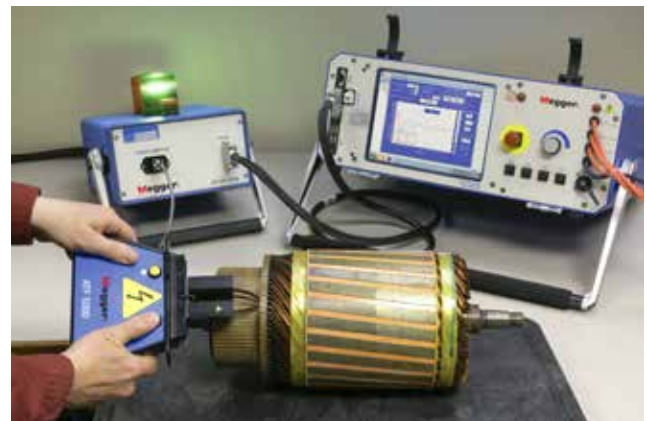
使用ZTX附件和ATF5000换向器探针来测试电枢
