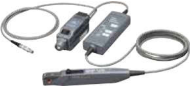
电流探头 0.5, 5, 30Arms, 702915 (DC ~ 50MHz), 702916 (DC ~ 120MHz)
