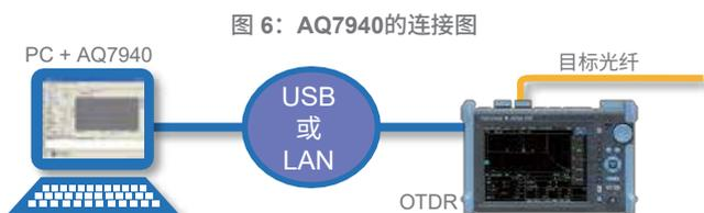
如果一台PC安装了AQ7940，且AQ7280通过USB或以太网远程连接<sup>5</sup>，AQ7280可以集中测量并传送测量数据到PC，而不需要处理波形，PC会处理波形。通过这样提高处理速度，可以实现100ms瞬间中断的检测。通过以太网连接，安装有AQ7940的一台PC最多可以处理四台AQ7280设备。
