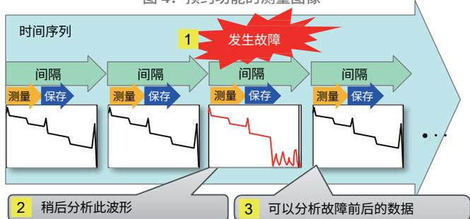
即使问题自动恢复，用户也可以获取和分析故障期间测量的数据，以检测故障位置。另外还保存了故障前后测量的数据，以便进行历史数据分析。
