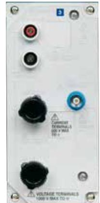
同台仪器主机上可以同时安装2A和30A输入单元。这样工程师们只需一台WT3000E就可以实现多种应用, 如测量待机功率、评价被测设备的各种工作模式等。
