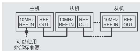
连接方法2(最多连接4台)
